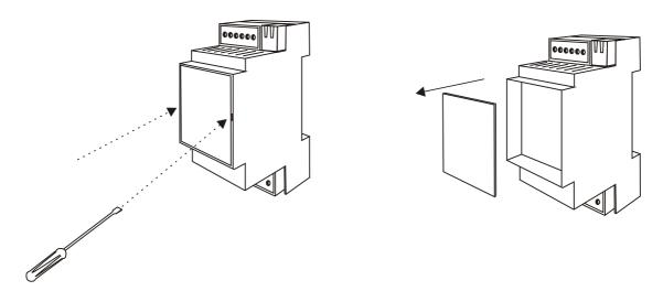
Una vez quitada las placas podrá ver un circuito impreso sobre el cual están los switches de configuración y los LEDs.
