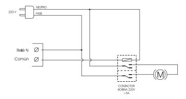
Si lo desea puede utilizar un relé auxiliar con bobina de 24 voltios y compartiendo la alimentación de los módulos TCP/IP ModBus. Observe que el relé corta los dos hilos de alimentación (fase y neutro), lo cual es siempre recomendable para cargas grandes.
