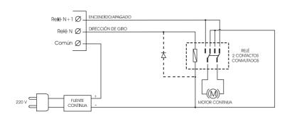
**NOTA:** Debe tener presente que los relés que montamos en nuestros equipos están garantizados por el fabricante para conmutar cargas resistivas de hasta 5 A. Muchos dispositivos, tales como motores, bobinas, ..., no son cargas resistivas y con toda seguridad en el arranque el consumo sea muy superior al indicado.
