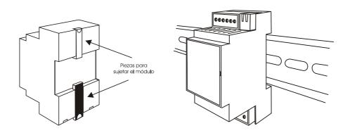
Para extraerla del carril DIN deberá insertar un destornillador en el arquito negro visible en la parte inferior y hacer un poco de palanca mientras estira con suavidad la parte inferior.
