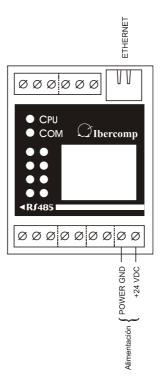
A través de http los módulos pueden ser accedidos simultáneamente desde varios equipos, mientras que a través de TCP/IP Modbus solo podrán ser accedidos desde un único master, tal y como se describe en las especificaciones modbus.
