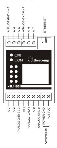
Como ya hemos indicado anteriormente las entradas pueden ser configuradas para medir tensiones de 0 a 2V5 o de 0 a 10V. También es posible intercalar una resistencia de 124 Ohmios para medir corrientes de 0 a 20 mA.
