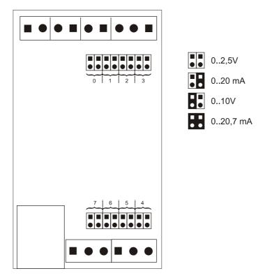
La opción b es una conexión directa al conversor analógico/digital que se encuentra dentro del equipo, dispone por tanto de una impedancia de entrada muy alta. Las configuraciones b y d están ideadas para conectar sondas del tipo 0..20mA o 4..20mA, y tienen una impedancia de entrada muy baja (del orden de 125 Ohmios).
