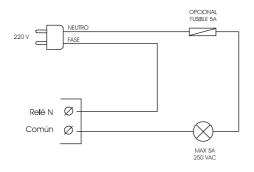
Si desea conectar una carga de más de 5 A o bien que tenga una componente inductiva importante, deberá añadir al sistema un relé externo o contactor que sea capaz de gobernar dicha potencia.
