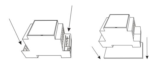
Una vez halla sacado la placa base podrá configurar adecuadamente los Jumpers del equipo. Si lo desea puede extraer la tarjeta CPU, aunque en ella no hay nada que configurar. La tarjeta frontal no puede desmontarse fácilmente sin romperse la caja, por tanto no lo intente.
