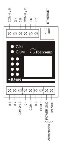
Esta tarjeta dispone de 8 salidas a relé de 1 contacto cada uno. En principio cada relé debería disponer de dos contactos que se cierran cuando se activa el relé. En nuestro equipo debido a la falta de espacio alguno de estos relés disponen de una conexión común.
